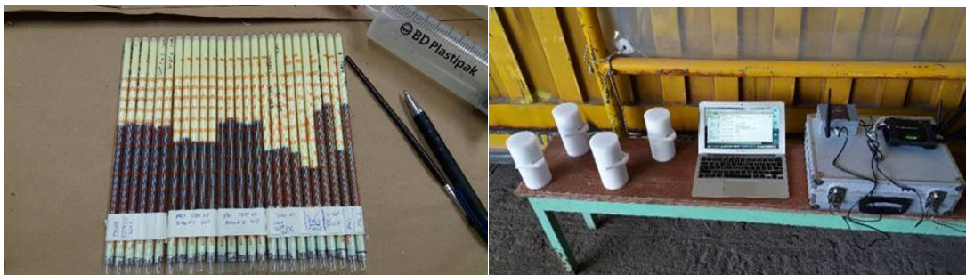
Εικόνα 15: Μέτρηση της συγκέντρωσης με τη χρήση σωληνίσκων που μεταχρωματίζονται ανάλογα με την παρουσία του αερίου και ηλεκτρονικών αισθητήρων.
