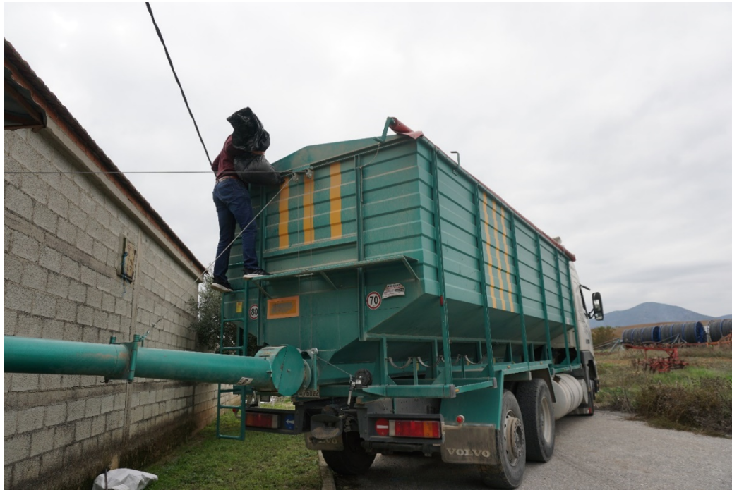
Εικόνα 7: Εφαρμογή γης διατόμων κατά την εκφόρτωση του σιταριού στην αποθήκη.
