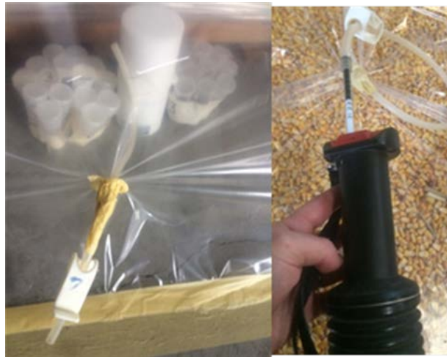
Εικόνα 17: Τοποθέτηση υποδοχής για σωληκίσκους μέτρησης φωσφίνης (αριστερά) και μέτρηση της συγκέντρωσης με αντλία (δεξιά).
